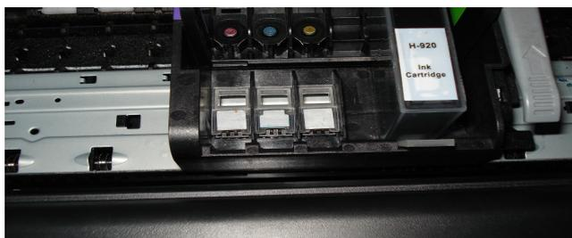
Nach dem sie die Chips der Originalpatronen oder des kompatiblen Chipsatzes auf jedem Extender angebracht haben legen sie die Extender, wie in der Abbildung links in den Druckkopfschlitten ein.
